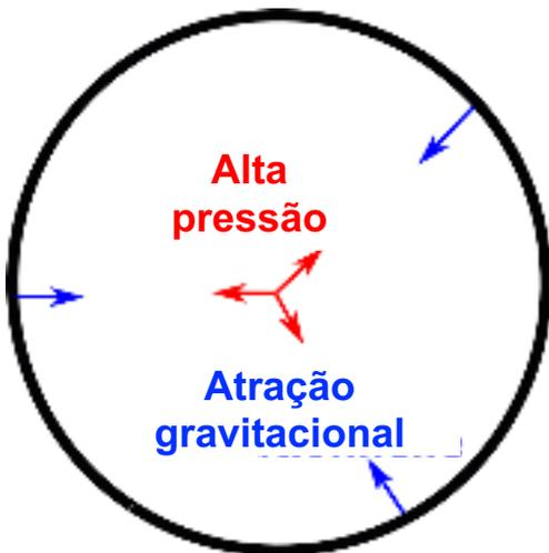
Uma estrela está em equilíbrio entre a ação da **pressão térmica** para fora e a ação da **gravidade** para dentro.
